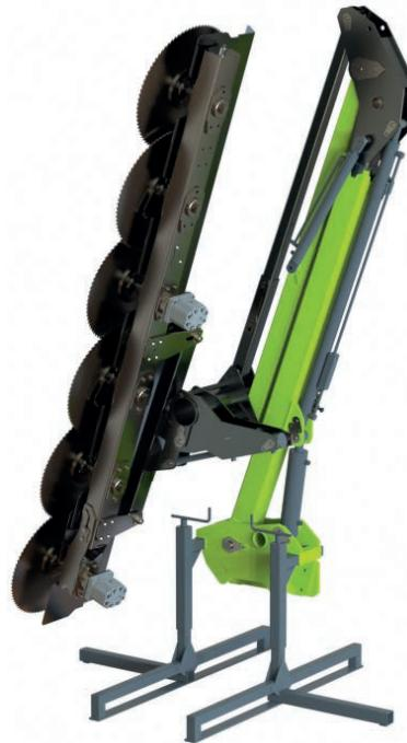
Prepodadora con discos especiales para arbolado tanto para cultivo intensivo como tradicional, para ser montada delante del tractor. El corte puede ir de ramas hasta Ø8 cm, según el disco montado.
