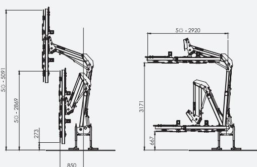
■ Prepodadora con discos especiales para plantaciones en palmeta y arbolado en intensivo, para ser montada delante del tractor. Con cabezal horizontal con palpador mecánico. La versatilidad de esta máquina permite realizar la poda en horizontal y vertical al mismo tiempo. El corte puede ir de ramas hasta Ø8 cm, según el disco montado.
