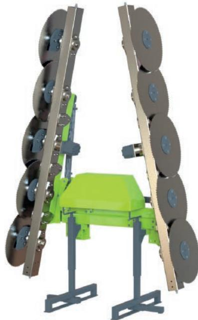
Prepodadora doble con discos especiales para arbolado tanto para cultivo intensivo como tradicional de gran tamaño y altura, para ser montada delante del tractor. El corte puede ir de ramas hasta Ø8 cm, según el disco montado.
